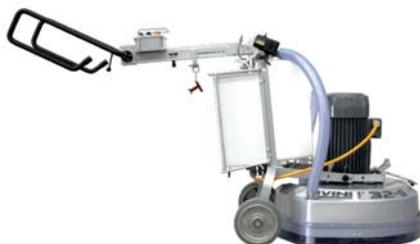
Предназначена для больших объемов работ по шлифовке и полировке, идеально для больших складских помещений
